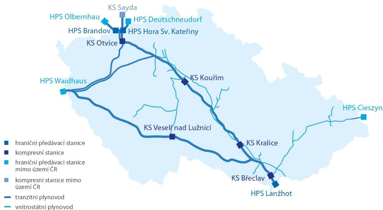
Obrázek 4.1: Přepravní soustava provozovaná společností NET4GAS
