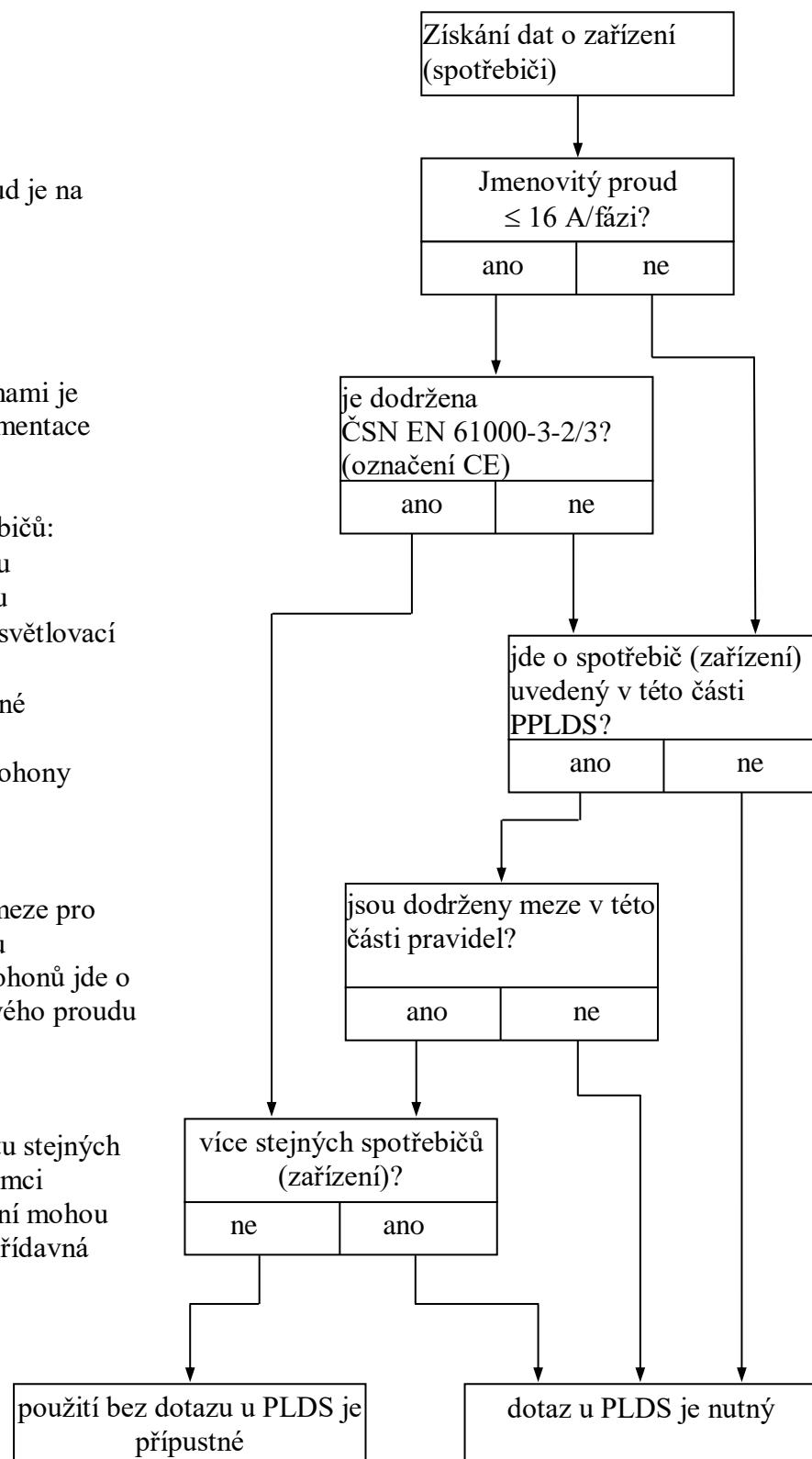
Obr. 1 Schéma po posuzování přístrojů/zařízení se zřetelem na elektromagnetickou kompatibilitou EMC)
