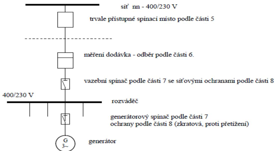
**Příklad 3 Jedna vlastní výrobna v paralelním provozu se sítí bez možnosti ostrovního provozu**
