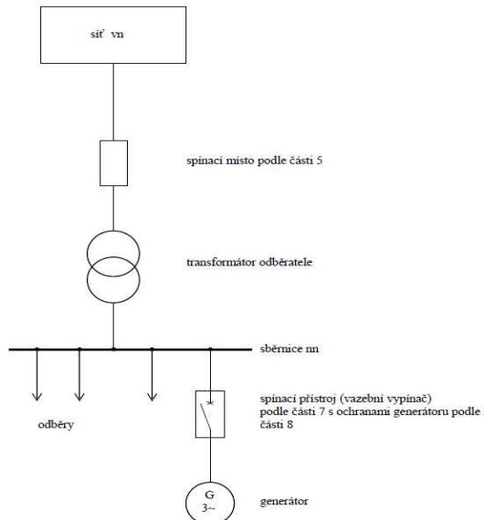
**Příklad 4 Výrobna s více generátory v paralelném provozu se sítí bez možnosti ostrovního provozu.**
