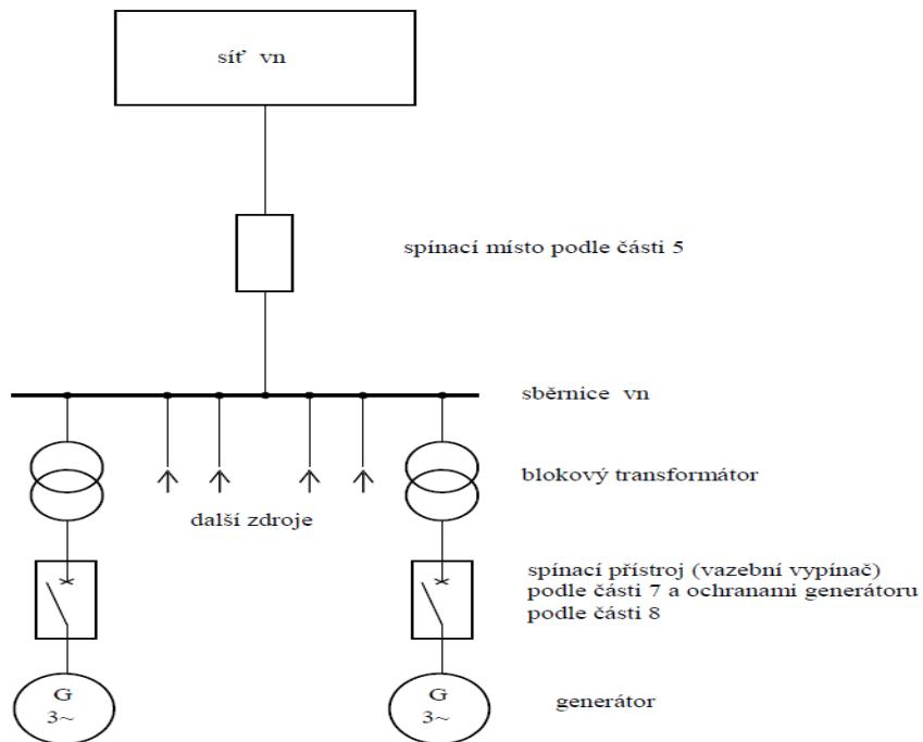
**Příklad 8 Výrobna s více generátory v paralelním provozu se sítí bez možnosti ostrovního provozu, se sběrnicí VN a centrálním vypínačem s ochranami.**
