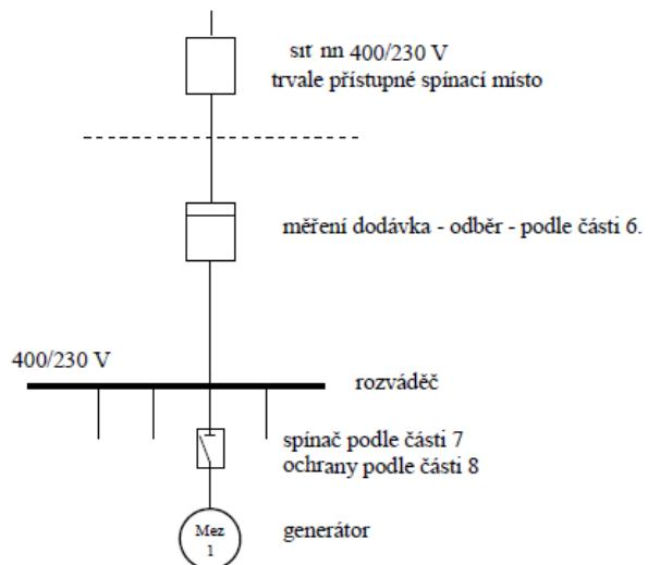
**Příklad 1a Paralelně provozovaná výrobná v síti NN bez možnosti ostrovního provozu**
