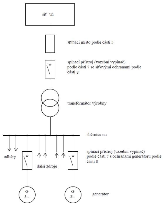
**Příklad 7 Výrobna s více generátory v paralelním provozu se sběrnicí VN a decentralizovanými vypínači s ochranami.**
