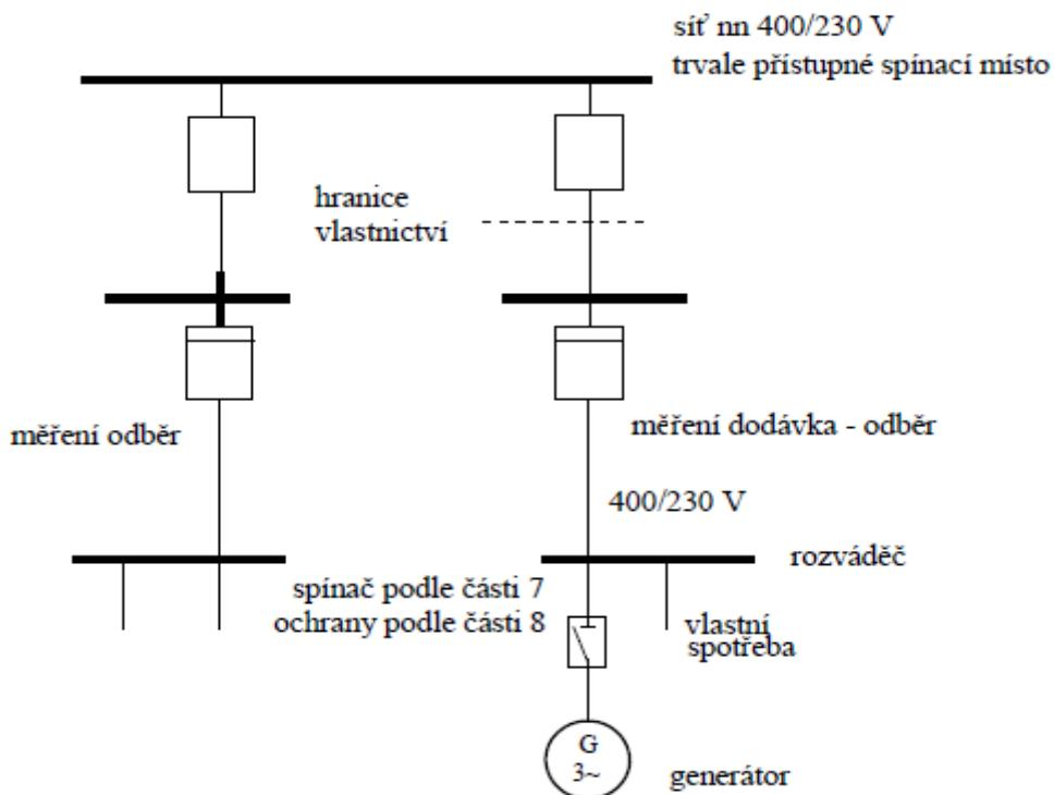
**Příklad 2 Paralelně provozovaná výrobna v síti NN s možností ostrovního provozu**
