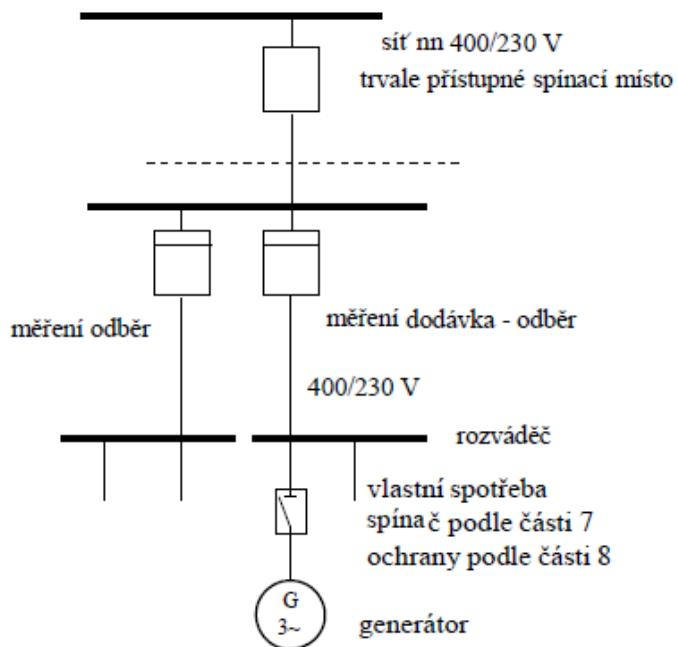
**Příklad 1b Paralelně provozovaná výrobna v síti NN bez možnosti ostrovního provozu**
